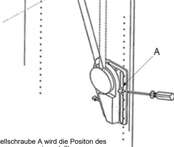
1. Die Halterungen des Garderobenliftes werden im vorder Bereich der Reihenlochbohrungen angebracht. Entfernen Sie dazu die Abdeckkappen mit einem Schlitzschraubendreher. Höhe von oben mind. 59 cm.
